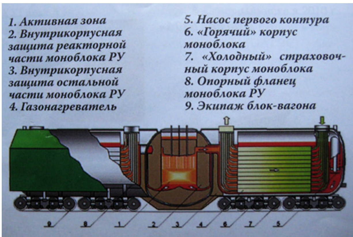
Проект блочної АТЕЦ зі швидким натрієвим реактором
